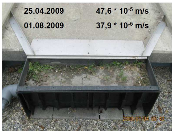
Obr. 8 vysušený filtr. žlab
